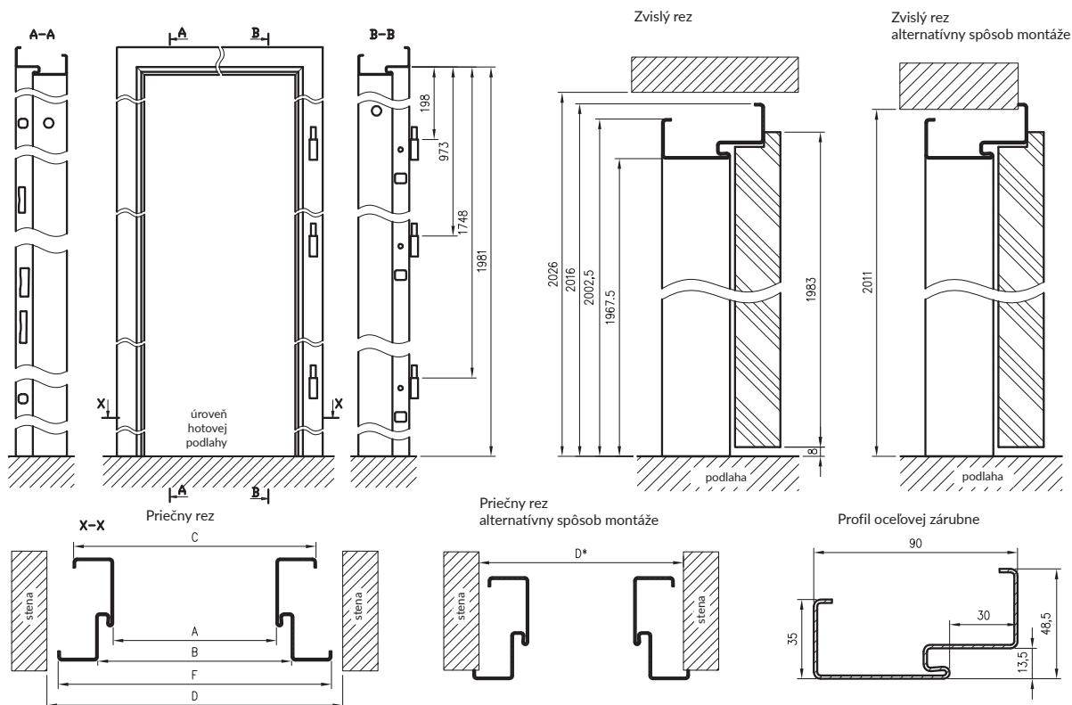
Vyžadovaná výška otvoru v stene meraná od hotovej podlahy je 2086 mm alebo 2071\*mm v prípade alternatívneho spôsobu montáže
