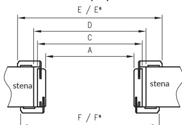
D – požadovaná šírka otvoru v stene
