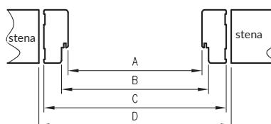
D - požadovaná šírka otvoru v mure
