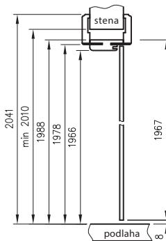
požadovaná výška otvoru v múre ORC = 2010 mm, OR = 2013 mm
