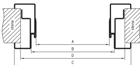
Profil oceľovej zárubne nastaviteľnej s uholníkom uzatváracím T57
