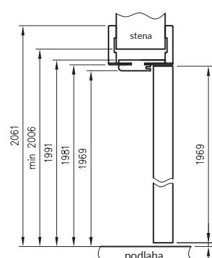
požadovaná výška otvoru v múre 2006 mm
